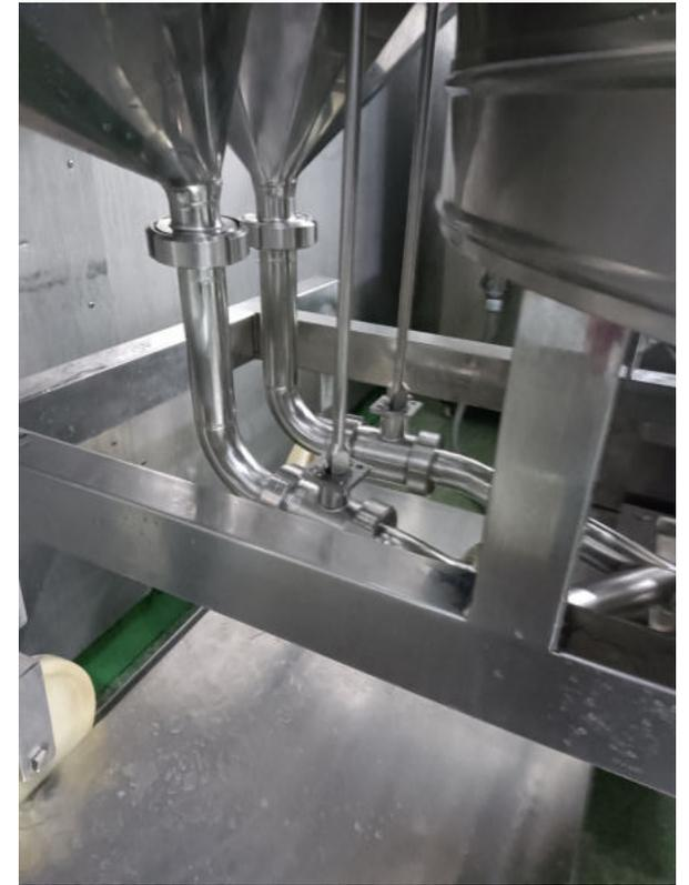
Al fine di rendere lavabili tutte le parti della macchina sono state rese smontabili alcune parti permettendo la completa sanificabilità della macchina
